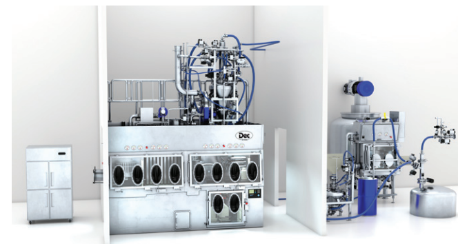
FIGURA 9. Aisladores de mayor contención (alto OEB).
