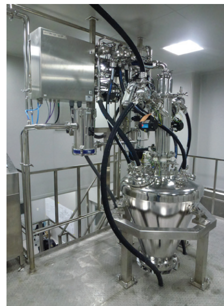
FIGURA 3. El sistema Batchmixer (Mezclador) se puede integrar fácilmente en una línea de proceso y puede mejorar la eficiencia de la operación y disminuir el tiempo total del lote. Sin partes giratorias.
