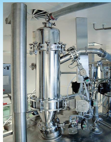
FIGURA 1. Presentación de la tecnología PTS (Powder Transfer System).
